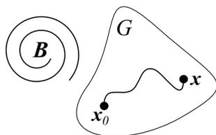
Abbildung 1: Das Elektron bewegt sich im magnetfeldfreien Gebiet  $G$  von  $\mathbf{x}_0$  nach  $\mathbf{x}$ . Eine Spule erzeugt in ihrem Innern ein Magnetfeld  $\mathbf{B}$ , das senkrecht zur Zeichenebene steht.
