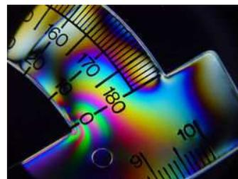
iv) Zwischen den Filtern werden zwei entgegengesetzte  $\lambda/4$ -Plättchen in den Lichtstrahl gelegt, und zwar eines auf jede Seite der Platte. Ein  $\lambda/4$ -Plättchen fügt eine relative Phase  $e^{\pm 2\pi i/4} = \pm i$  zwischen zwei ausgezeichneten linearen Polarisierungen ein. Letztere sollen um  $45^\circ$  gegenüber dem Filterpaar gedreht sein. Zeige: Die Isochromaten bleiben, die Isoklinen werden unterdrückt.
