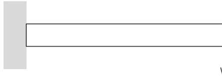
*Hinweis:* Die Verschiebung verschwindet am eingespannten Ende.
