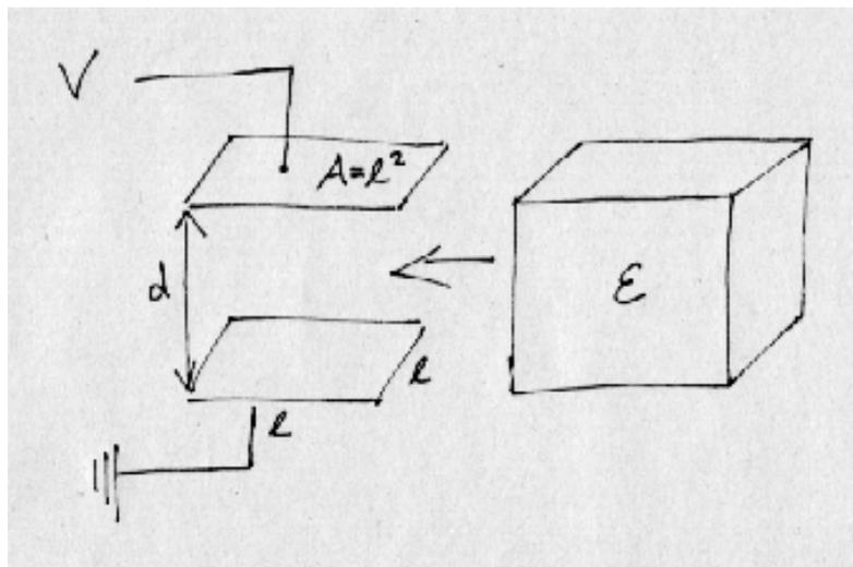
**Tipps:** Vernachlässige Randeffekte. Das heisst, nimm an, dass das elektrische Feld zwischen den Platten homogen ist und ausserhalb verschwindet.
