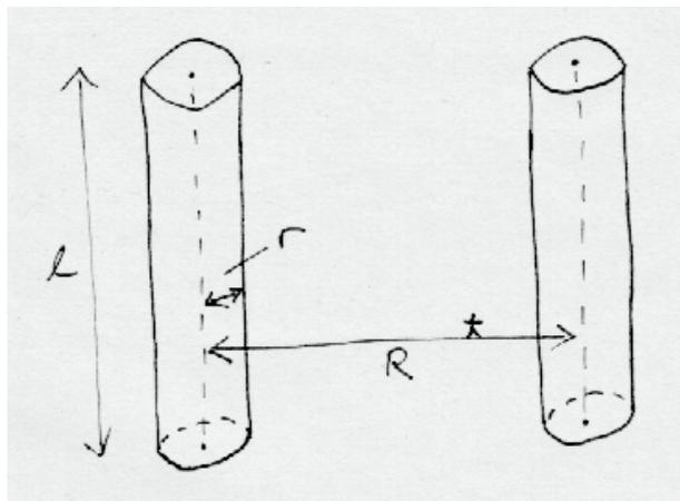
**Tipps:** Die direkte Anwendung der Formel aus dem Skript ist sehr aufwendig. Einfacher ist das Berechnen des Vektorpotentials eines Drahtes, und daraus anschliessend  $L$  mithilfe der potentiellen Energie  $W$ . Zur Berechnung von  $\vec{A}(\vec{r})$  bieten sich zylindrischen Koordinaten an. In diesen gilt
