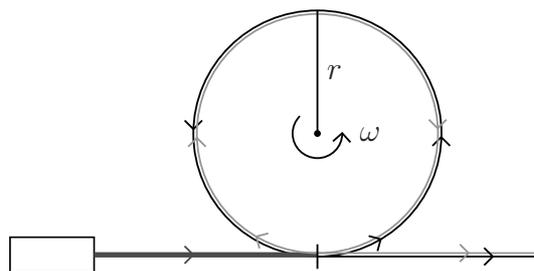
Man berechne die Phasendifferenz  $\varphi$  zwischen den Strahlen und ihre Veränderung  $\Delta\varphi$  infolge der Drehung: Bei Vernachlässigung von  $O(\beta^2)$ ,  $\beta = \omega r/c$ , ist
