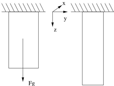
Vergleiche die resultierende Deformation  $\vec{u} = (u_x, u_y, u_z)$  mit derjenigen eines aufgehängten elastischen Stabs im Schwerfeld, d.h. unter dem Einfluss der Volumenkraft  $\vec{F}_G = \rho g$ , mit der homogenen Massendichte  $\rho$ . Berechne dazu den entsprechenden Spannungstensor  $\sigma_{ij}$  unter Verwendung der korrekten Gleichgewichts- und Randbedingungen.
